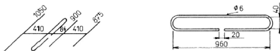
Obrázok č. 3.22 Anténa typu YAGI – 4 prvková – rozmery anténového žiariča pre frekvencie v pásmi VKV.
